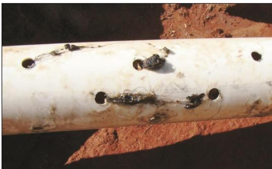
Figura 5 – Presença de fios de cabelo nos furos dos canos que dão vazão ao esgoto sobre a ETEZR's.
